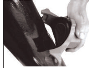
3. Conta montajı Gasket installation
