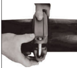
5. Kaplin gövdesi kurulumu Housing installation
